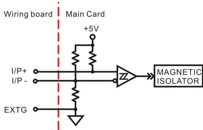
For encoder feedback input : A+/-,B+/-,Z/-
